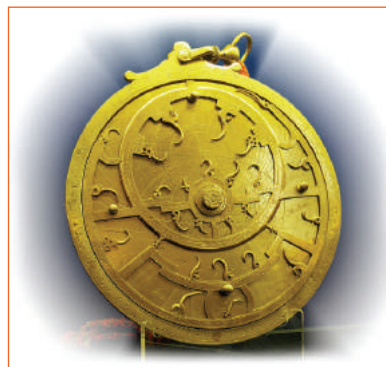
► Astroláb – významný navigační přístroj vynalezený muslimy. Ostré hroty na přední kruhové straně, rete, označují pozice nejjasnějších hvězd, jejichž jména jsou vyznačena na základně každého hrotu. Na zadní straně základní desky, mater, jsou vyryty souřadnice. (Whipplevo muzeum dějin vědy v Cambridgi, Velká Británie).
